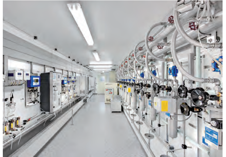
Modularer Aufbau mit Trennung von wet & dry part Modular design separated in wet & dry part
