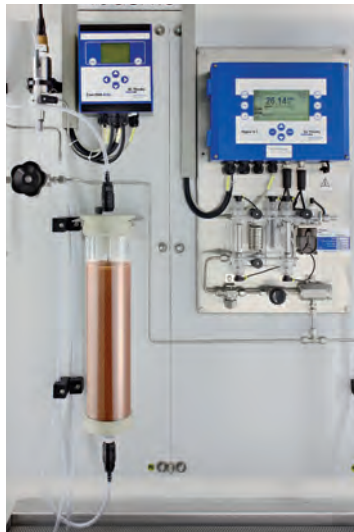
Analysenteil mit Leitfähigkeits- und O 2 - Messung Analysing equipment with measurement of conductivity and oxygen
